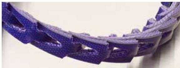
**Tango Friction Top** tiene una capa de poliuretano 85A incorporado en cada enlace, que ofrece un mayor coeficiente de fricción para lograr que el producto no se resbale.
